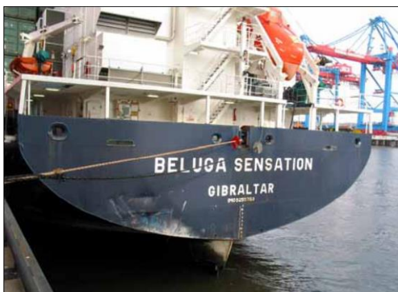
Abbildung 3: BELUGA SENSATION Heckschaden
